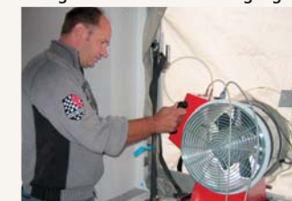
Blower Door-Test mit Bauleiter Heiko Wolf, hier wird die Dichtigkeit gemessen.
